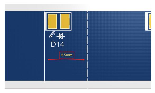
因为客户机器放触摸条的型材<mark>上下长度不一致</mark>,所需现在需要裁剪掉 4 号板前面 2.5mm 与 5 号板尾部 2.5mm 【固件需要屏蔽 X 轴首尾灯 】
